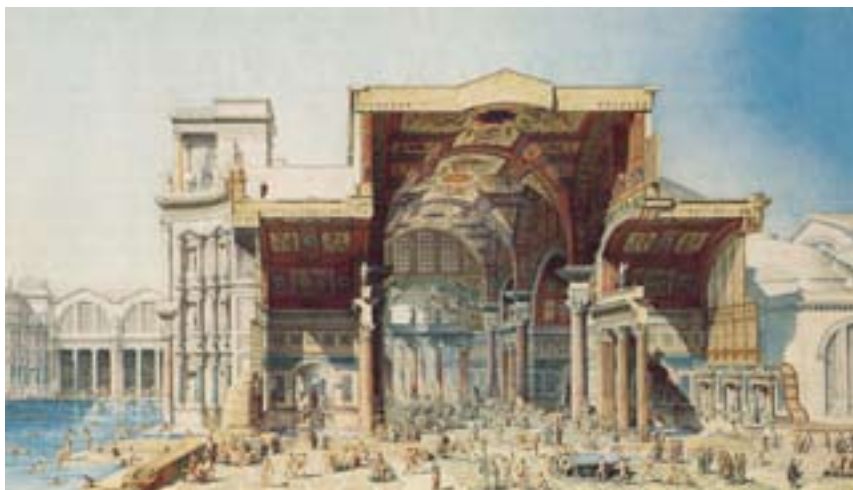
Terme di Diocleziano, sezione trasversale prospettica del frigidarium, ricostruzione (disegno di Edmond Paulin, 1885)
